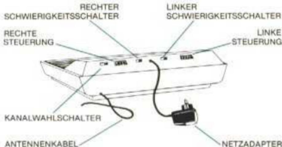
■ Schließen Sie das Antennenkabel des ATARI Video Computer Systems an den Antennen-Eingang Ihres Fernsehgeräts an.
