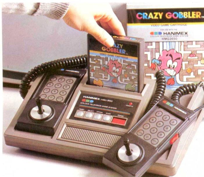
*Le cassette dei giochi si inseriscono in un particolare connettore sul frontale della macchina. In assenza della cassetta il connettore viene automaticamente protetto dalla polvere da una flangia a scomparsa.*
