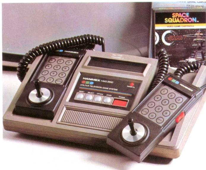
*L'Hanimex si presenta come una console con i due controller laterali separabili e collegati mediante un filo estensibile. Questi ultimi sono dotati di una tastiera, di pulsanti laterali e di un joystick per il controllo delle direzioni nei giochi che lo richiedono.*
