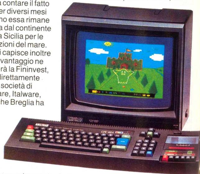
milione: 998.000 più Iva. Un apparecchio dunque interessante, con video a 80 colonne, risoluzione di 640 x 200 pixel e 27 colori, gestione del video con otto finestre, tre voci con otto ottave, linguaggio BASIC, un proprio sistema operativo e possibilità di implementare il CP/M.
