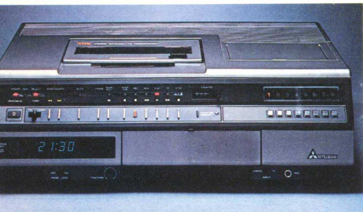
Il Mitsubishi HS 300Y è un VHS della seconda generazione, con tastiera logica servoassistita, orologio/timer digitale, tuner elettronico.
